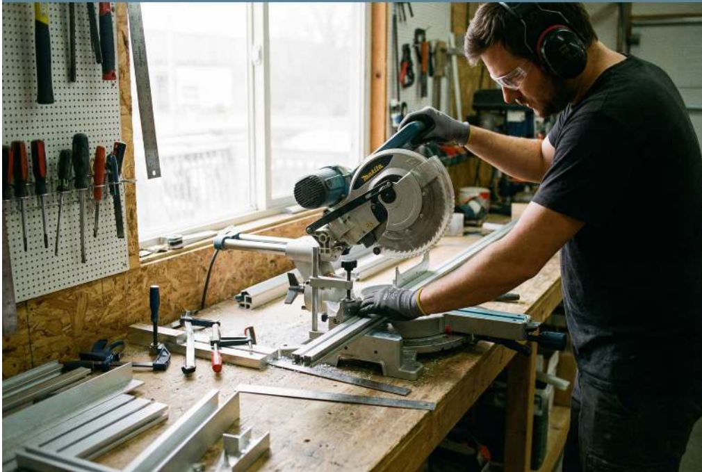
Préparation de dormants en aluminium avec une scie à onglet, précision requise
