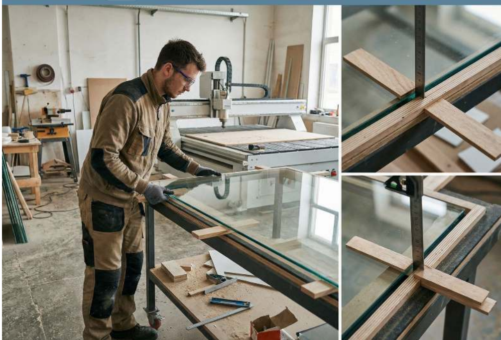
Préparer un vitrage avec un jeu de 12 mm améliore l'étanchéité
